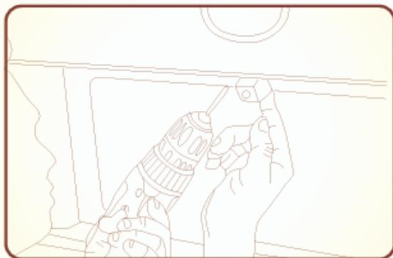
4. Ajuste el ángulo vertical de la cámara y luego fije el tornillo.
