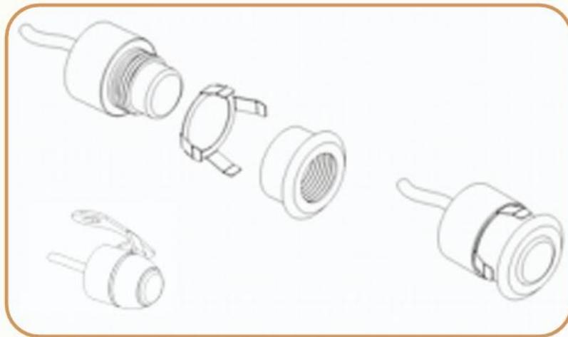
2. Como se muestra en el diagrama, cambie la carcasa frontal de la cámara colgante por una empotrada/perforada.
