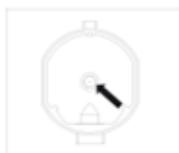
Cuando reemplace la boquilla del quemador, suelte la boquilla con una llave especial (7) Fit Nueva boquilla, adecuada para el gas requerido type (ver tabla de referencia arriba)
