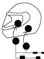
Coloque los altavoces en las posiciones de velcro a ambos lados del casco (cable corto para el altavoz izquierdo, cable largo para el derecho).
