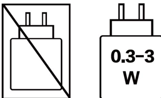
La **potencia suministrada por el cargador** debe estar entre un mínimo de **[0.3] vatios**, requeridos por el equipo de radio, y un máximo de **[3] vatios** para alcanzar la velocidad máxima de carga.
