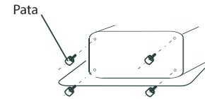
Si la unidad va montada, se requiere un rack seguro para prevenir la vibración y asegurar estabilidad. Se debe dejar al menos 15 cm entre la unidad y las paredes. (el rack no está incluido)
