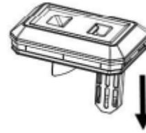
4. Retire el soporte del flotador.
