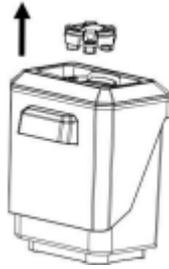
5. Pellizque el botón de la caja de solución y gírelo en sentido antihorario para desbloquear. Levante la válvula de control y vierta la cantidad adecuada de agua o solución en la caja.
