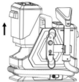
1. Deslice el botón del tanque de agua y tire del tanque de agua limpia verticalmente.
