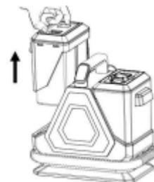
2. Deslice el gancho de bloqueo del tanque de agua externo y retire el tanque de aguas residuales verticalmente.
