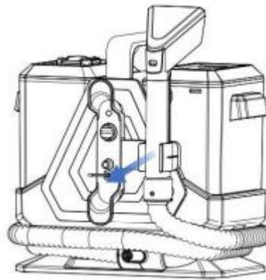
Para instalar: Inserte el cabezal de cepillo en el cilindro del cuerpo de la máquina y empujelo hacia adentro hasta escuchar un sonido de "pop". Esto indica que la instalación está completa.
