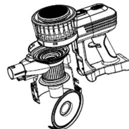
Limpie el **filtro HEPA** separando el ciclón y el filtro en la dirección de la flecha mostrada en la figura.
